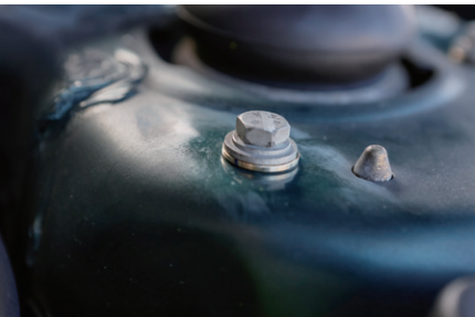
アルファロメオGTVの実際のサスペンションのボルト部。ここにオートローゼンの専用ワッシャーが装着されている
