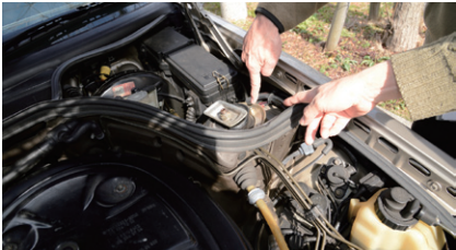
サスペンションのボルトとワッシャーの装着位置を確認
