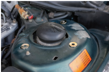
アルファロメオGTVの実際のサスペンションのボルト部。ここにオートローゼンの専用ワッシャーが装着されている
