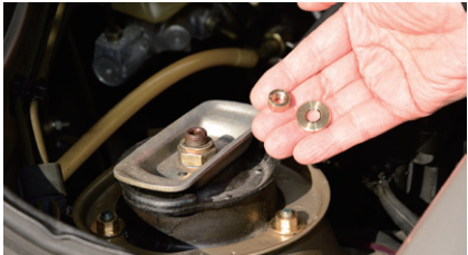
オートローゼン特製のボルトとワッシャーとその装着例
