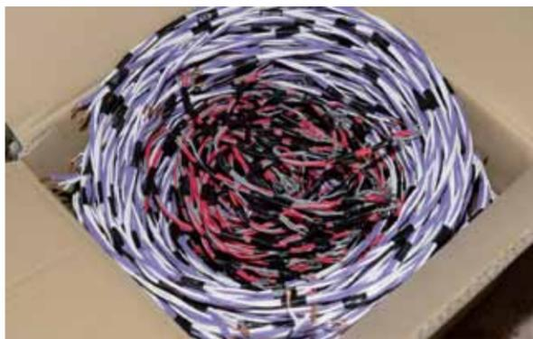
ねじりと長さの最適な組み合わせを得るために失敗を繰り返した試作ケーブル
