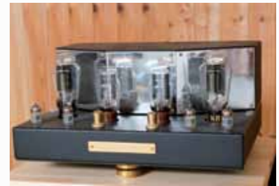
15Wの直熱管シングルアンプ「P-1EX」。A級シングル完全無帰還で、電気の流れや振動の流れも厳密に管理されている
